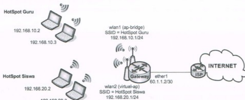
Gambar 4.21 Implementasi Virtual Access Point pada dua HotSpot
